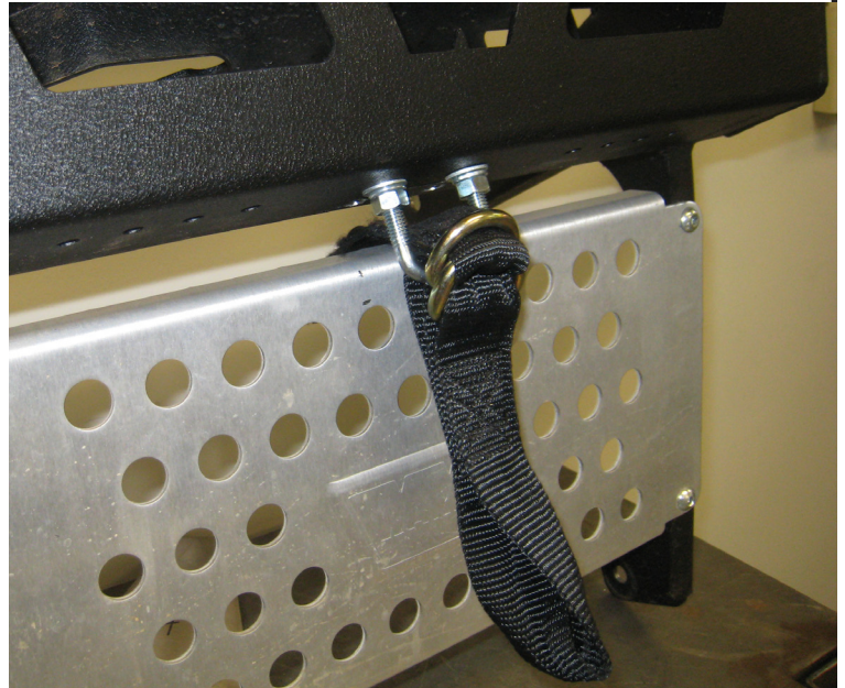
Raccordement de la sangle de terminaison au pare-chocs avant Warn.
